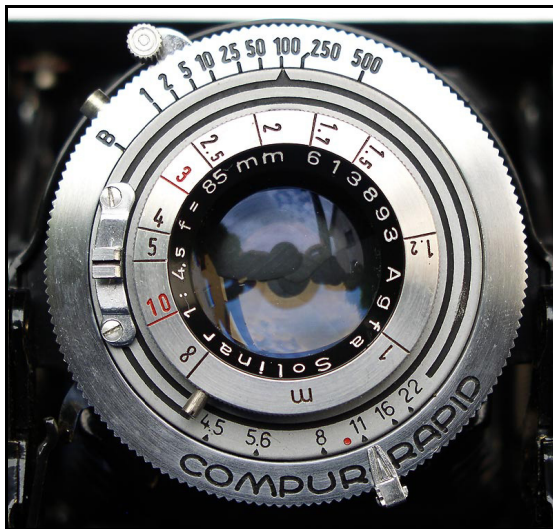
Compur-Rapid-Verschuß an einer Agfa Isolette
